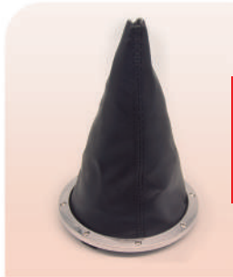
GOL G3 99/05 100159A - PRETO C/ ARO PRETO 100160A - PRETO C/ ARO CROMADO 100161A - GRAFITE C/ ARO CROMADO
